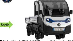
Prix de départ : 23 140 € TTC Type batterie: Lithium-fer-phosph Capacité de batterie: 7/14 kWh
