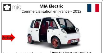
Autonomie: 130 KM (NEDC) Puissance recharge max.: 3,7 kW Prise: Type 1 CHAdeMO
